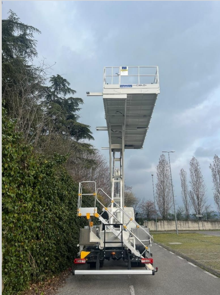
De SC Truck: een groot platform dat zijwaarts verschuift
