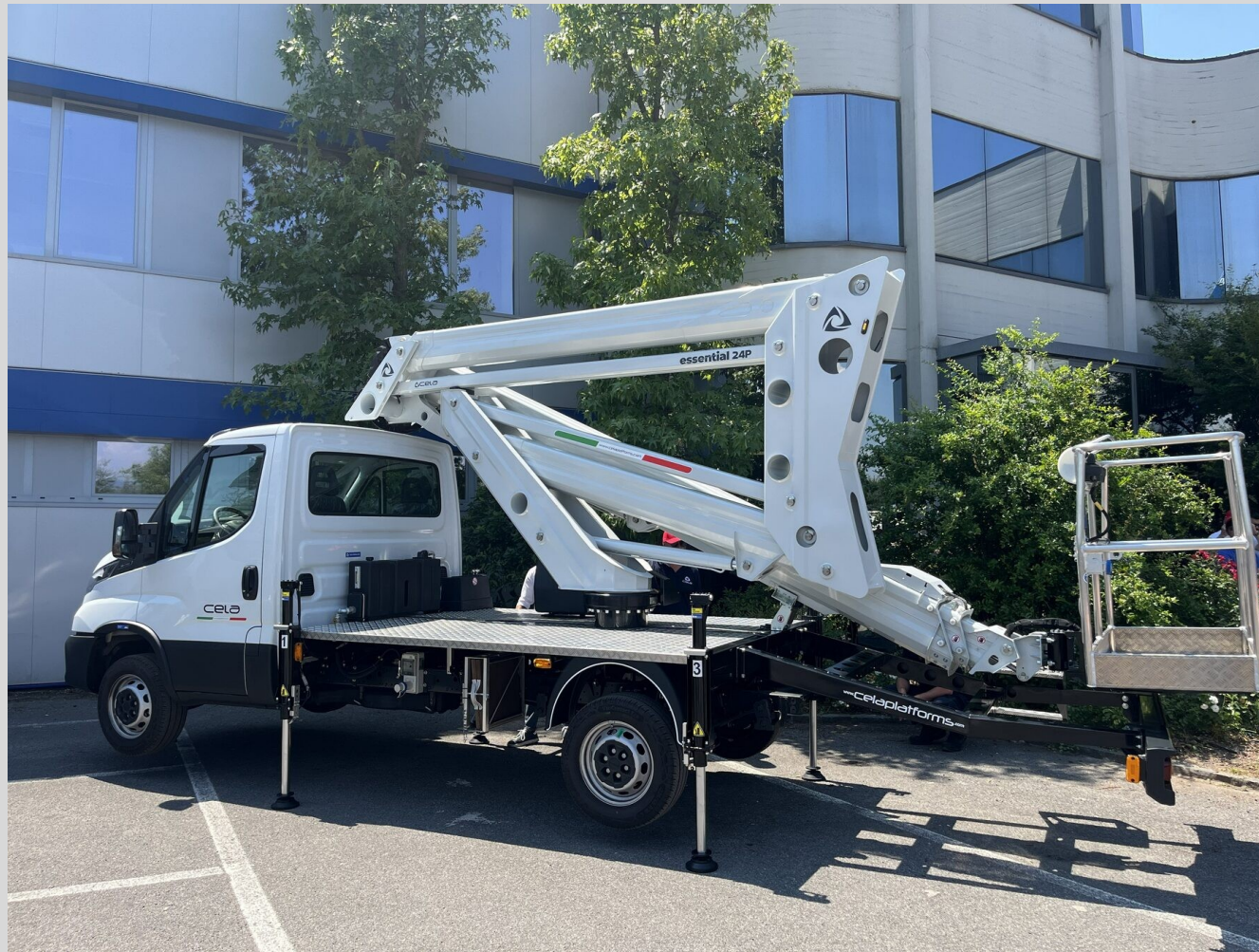
Cela Essential 24P: 24 m / 79 ft werkhoogte op een vrachtwagen van 3,5 t, te rijden met rijbewijs B
