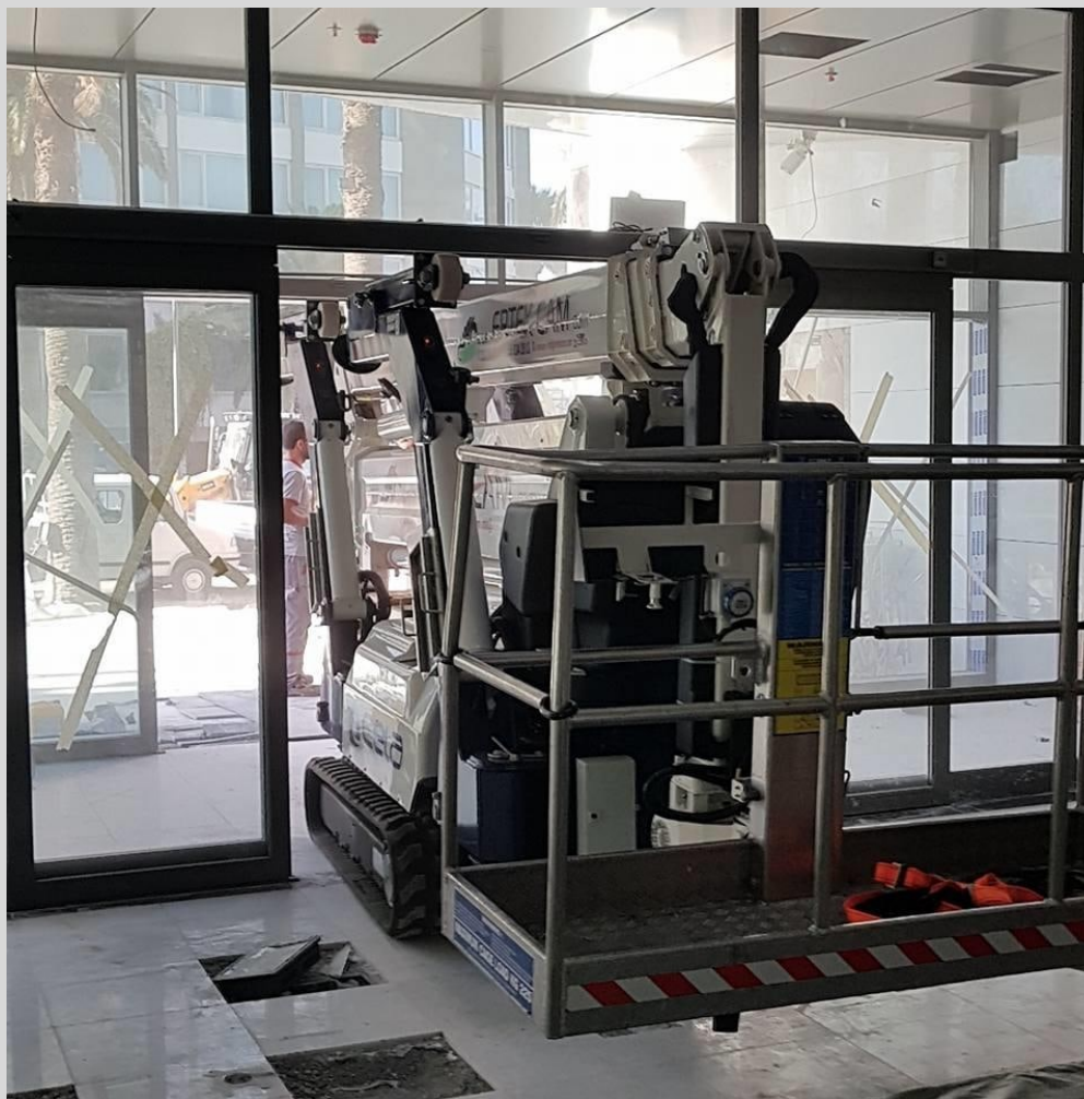
Gosenične ploščadi linije CELA Advanced DT so dovolj ozke, da zapeljejo skozi vrata stavbe
