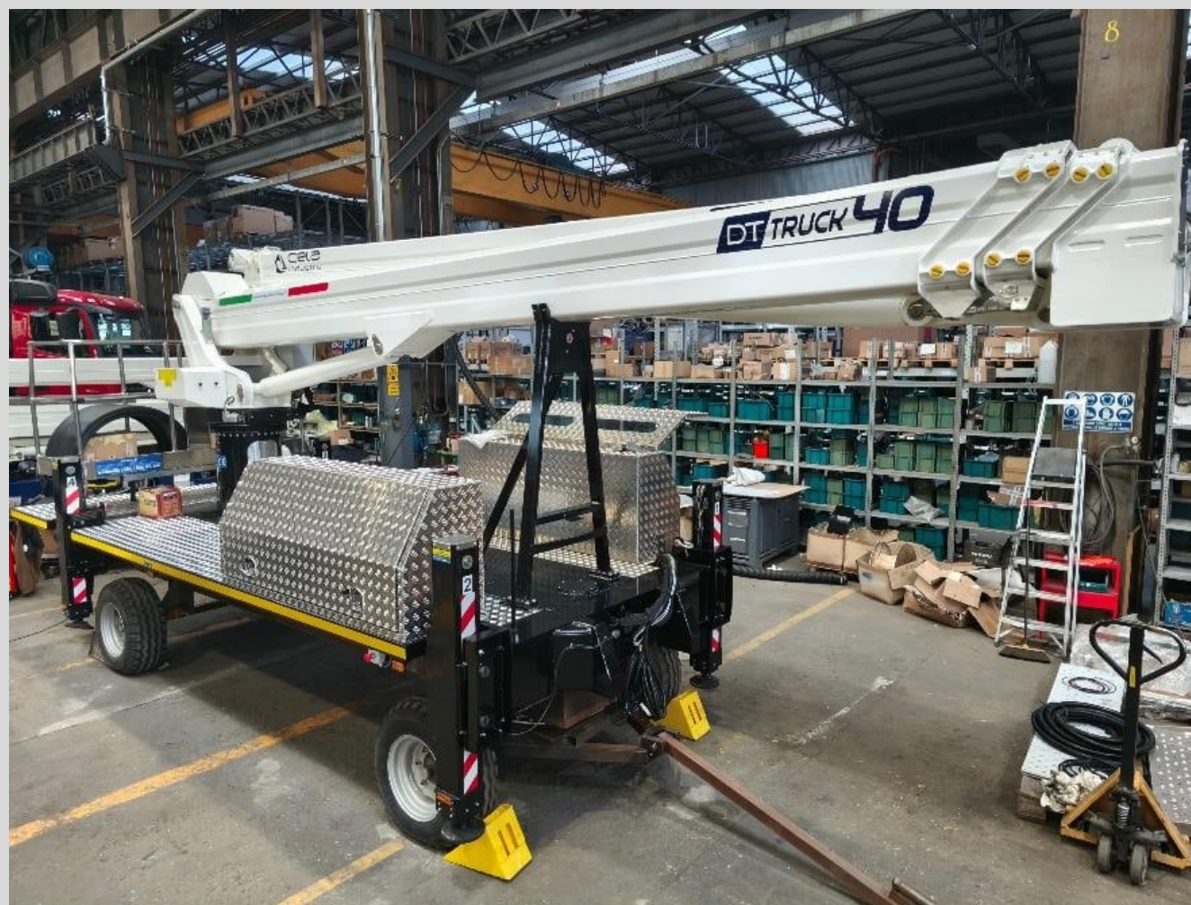
MAD KIT na cilju: zgornja struktura CELA na lokalno nabavljenem vozilu
