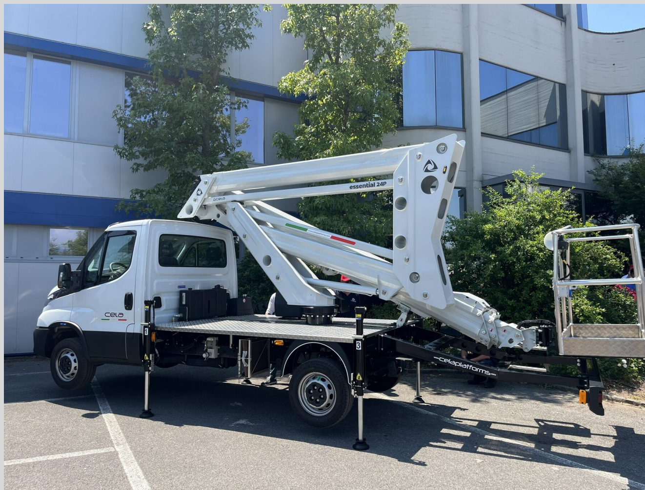
Cela Essential 24P: 24 m / 79 ft delovne višine na vozilu 3,5 t, ki ga vozite z vozniškim dovoljenjem B
